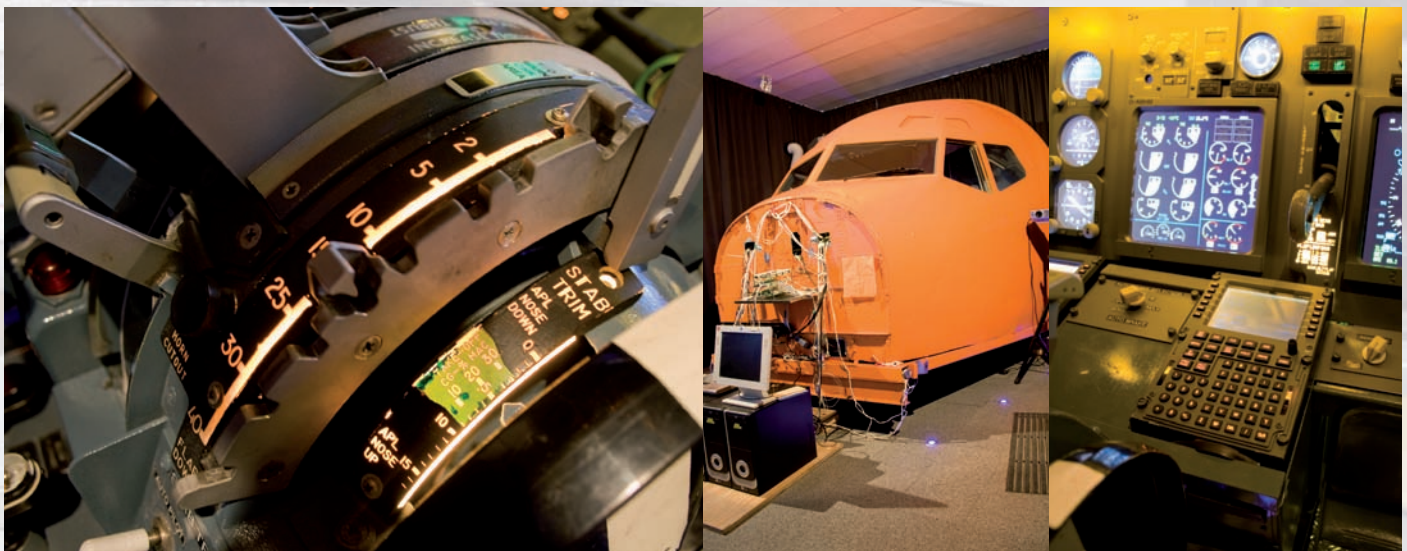
Eine Detailaufnahme des Throttles, die Shell mit Computern sowie Kabeln und ganz rechts das Panel mit Central Display Unit (CDU).
